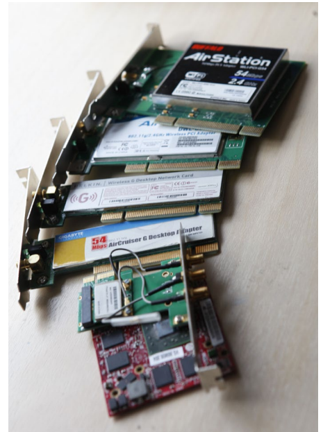
Valikoima laajennuskortteja. Edustalla kannettavan tietokoneen näyttöohjain (HD3650) sekä kannettavan PCI-E-väylän pöytäkonesovitin, taustalla WLAN-sovittimia.
